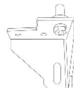
9. Verwijder de onderste scharnierpen en draai het onderscharnier 90 graden.
