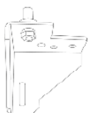
10. Vuelva a colocar el pasador de la bisagra inferior en la bisagra inferior que ha girado.
