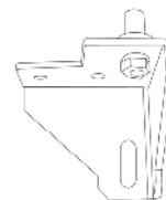
9. Démontez le pivot de la charnière au fond, et tournez la charnière 90 degrés.
