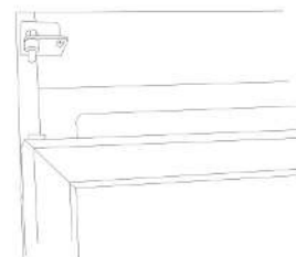
6. Illessze be a forgópánt csapját az ellenkező oldalon anélkül, hogy megszorítaná.
