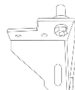
6. Coloque el pasador de la bisagra en el lado opuesto, sin apretarlo.
